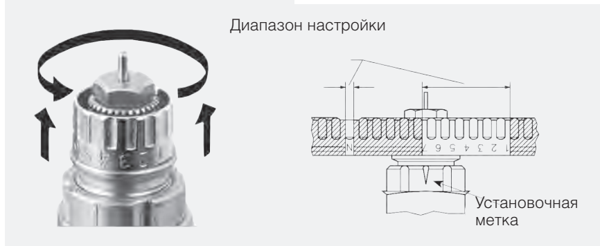
Рис. 19. Предварительная настройка клапана Danfoss
